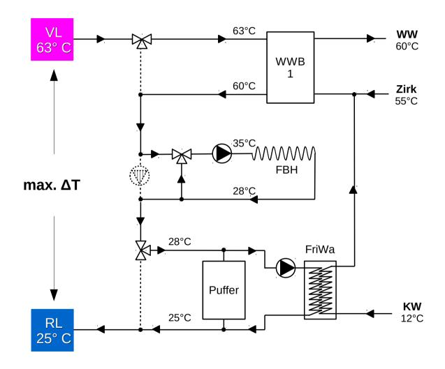
Vorteil: - keine Bevorratung von Trinkwasser im Vorwärmer, keine Aufheizpflicht gem DVGW W551: 60°C/1\*d - geringere Rücklauftemperatur im Sommer wegen Schichtung im Puffer
